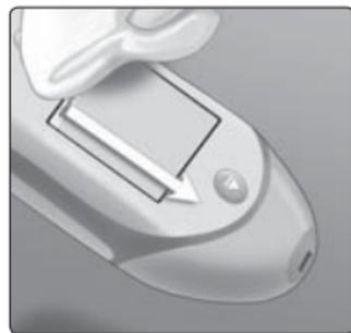
消毒剤でしみこませた柔らかい布かウェットティッシュの新しいものを使って、測定器の表面を湿らせて消毒します。測定器を拭く前に、必ず余分な液体を絞って取り除いてください。最低でも1分間は測定器本体が湿っている状態にしてください。
