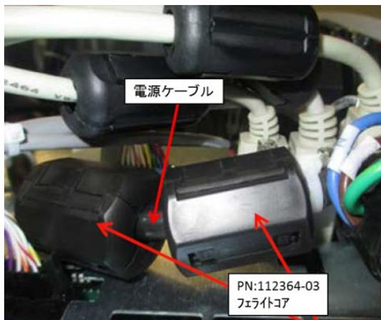
図2 電源ケーブル フェライトコアの取付け
